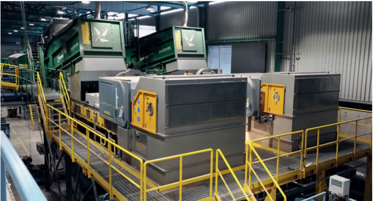
Kuva 4. Ballistinen erotin erottelee jätteitä muodon mukaan, kun taas optinen erottelija jakaa materiaaleja omiin jakeisiinsa (Päijät-Hämeen Jätehuolto Oy)
